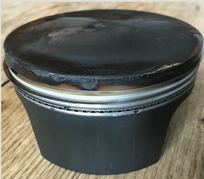
Fig. 3a: TA2 Piston, 500 race miles. Courtesy of Prefix Corp & Rafa Matos.
